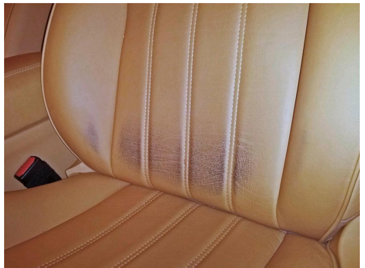
Jeansabfärbung auf Autoleder im Einstiegsbereich und Gürtelabfärbung auf das Leder vom Rückenpolster
