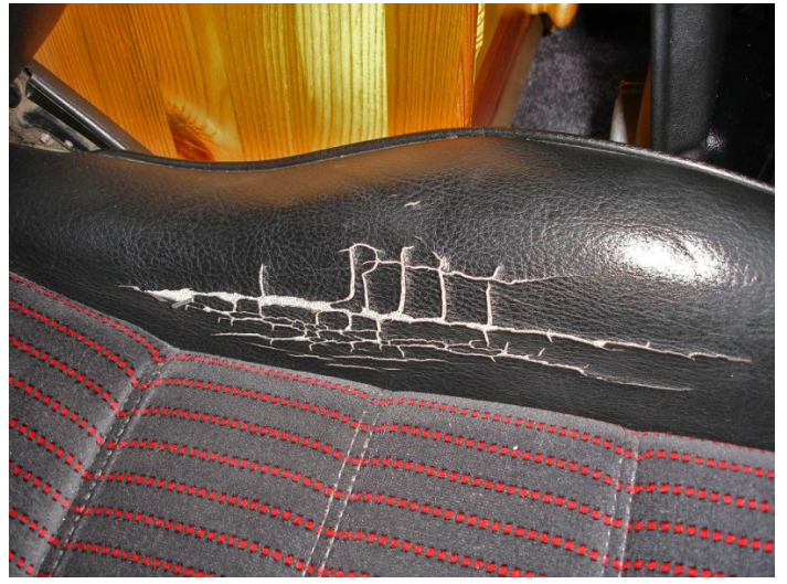
Einstiegsflanke bricht großflächig auf: Neubezug durch Sattler.
