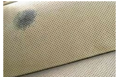
Perforierter Sitz mit Abriebflecken.
