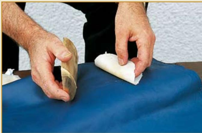
Weil die glatte Reparaturstelle auf dem genarbten Leder auffallen würde, erzeugt der Profi mit einer Kautschukplatte die passende Oberfläche
