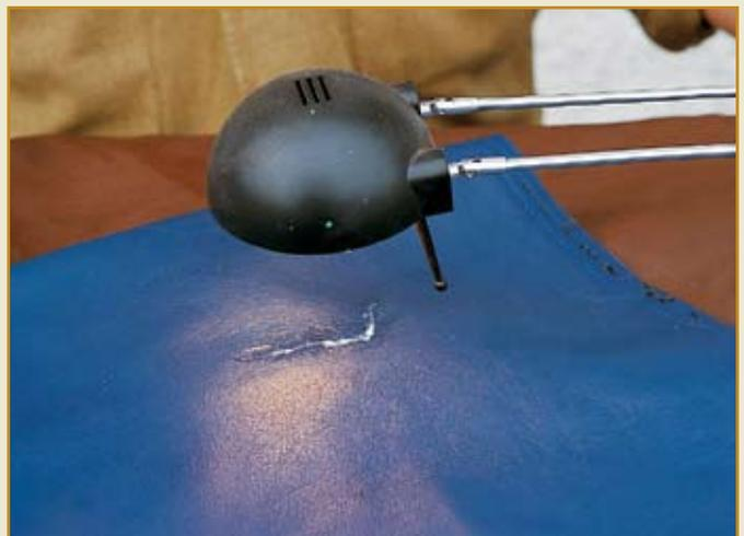
**Halogenlicht kann den Trocknungsvorgang des Flüssigleders bei Bedarf spürbar beschleunigen, aber wir haben mit der Naht etwas besseres vor**
