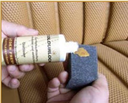
Die Tönung wird mit dem Schwamm aufgetragen. Sie egalisiert leichte bis mittlere Gebrauchsspuren
