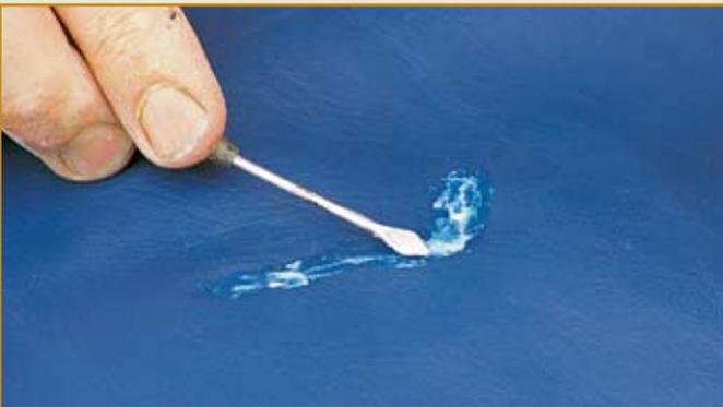
**Wenn die beiden Seiten des Risses richtig ausgerichtet sind, wird spezieller Lederkleber in die Nahtstelle eingebracht**
