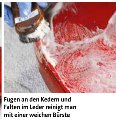
...um die Feuchtebelastung des Leders zu minimieren. Deshalb arbeitet man auch in kleineren Abschnitten
