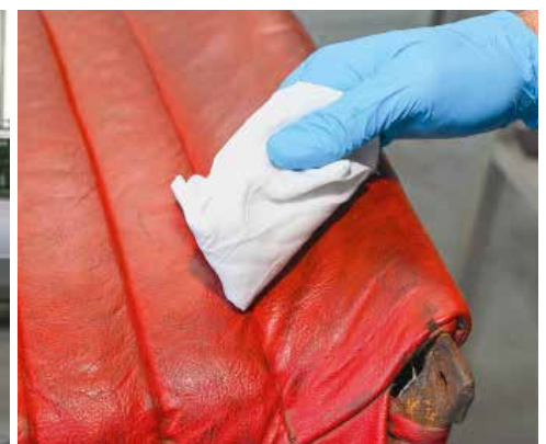
Beim Reinigen und Entfetten dürfen die Fugen zwischen den Pfeifen nicht zu kurz kommen
