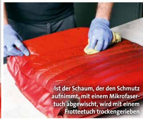
Die Grundreinigung steht stets am Anfang. Der Lederreiniger wird aus dem Schaumpender aufgetragen,...
