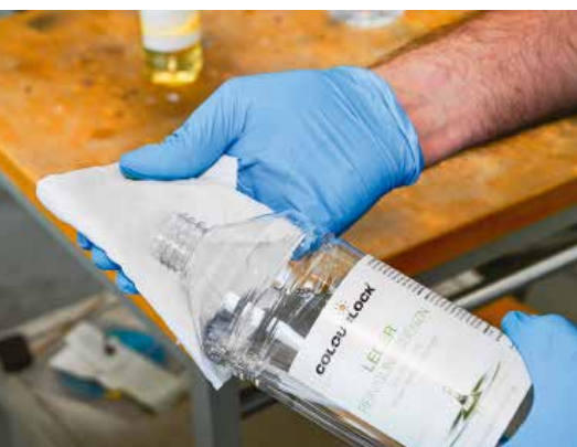
Vor Reparaturen und Farbanpassungen wird die Oberfläche mit Leder-Reinigungsbenzin entfettet
