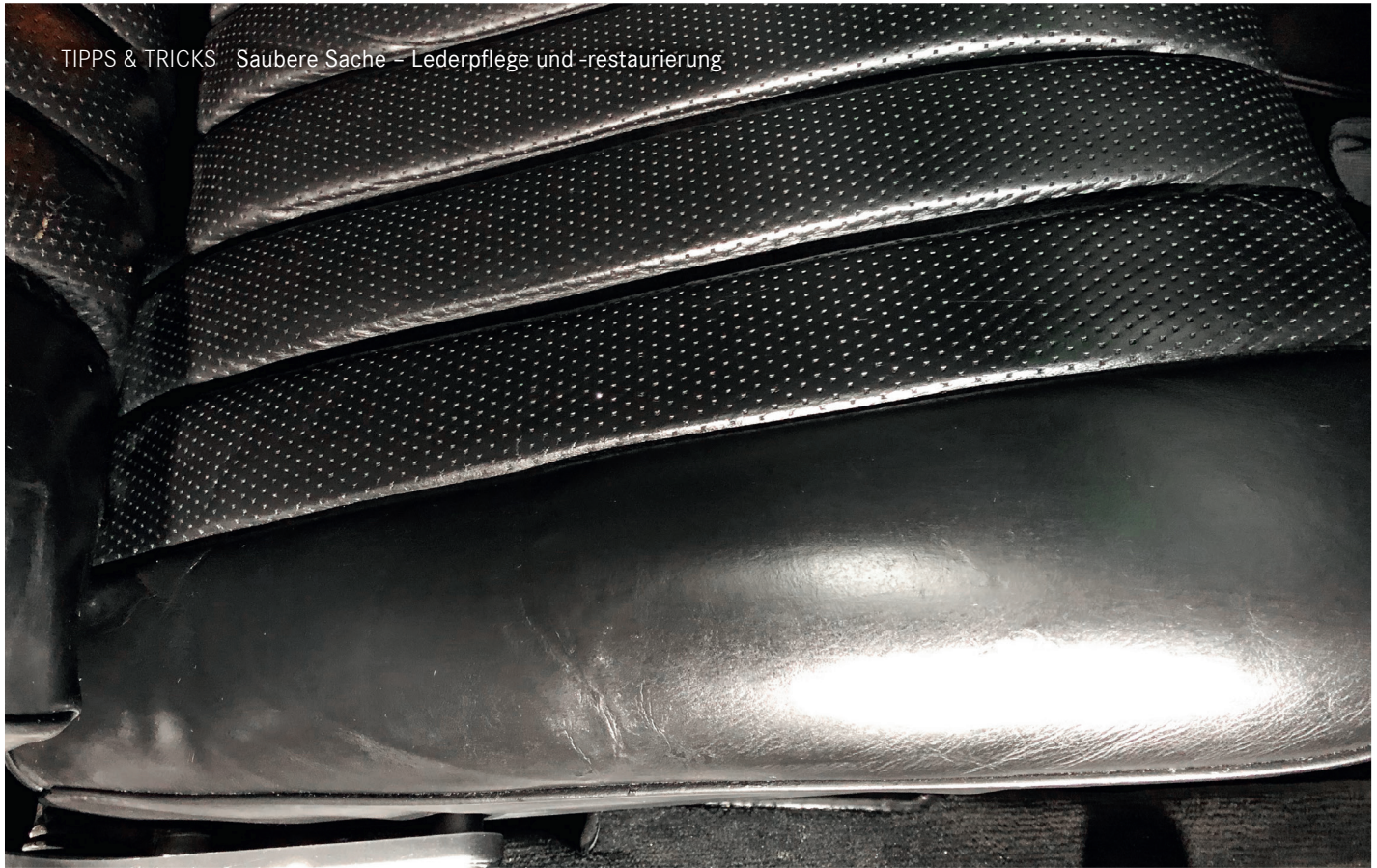
Finales Ergebnis nach dem Kleben, Füllen, Färben und Wachsen
