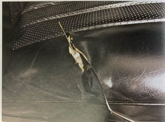
Unterfütterung zur Vorbereitung fürs Kleben.
