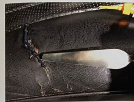
Auffüllen des Risses mit Flüssigleder.
